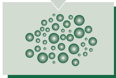
Die Flüssigkeit versucht der Frequenz zu folgen, schafft es ab einer bestimmten Frequenz nicht mehr. Die Kräfte werden aufgehoben. Dies führt schließlich zu einer Implosion von kleinen Vakuumbblasen und dazu, dass sich Moleküle voneinander und von der Oberfläche als feiner, submikron- und sogar nano-skalgigen Nebel lösen.
